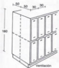
13 Hileras doble de armarios
