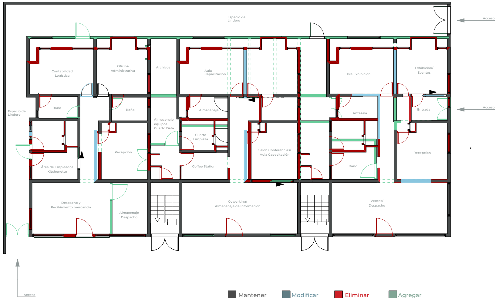
1 Plano Situación de Muros Escala 1:150
