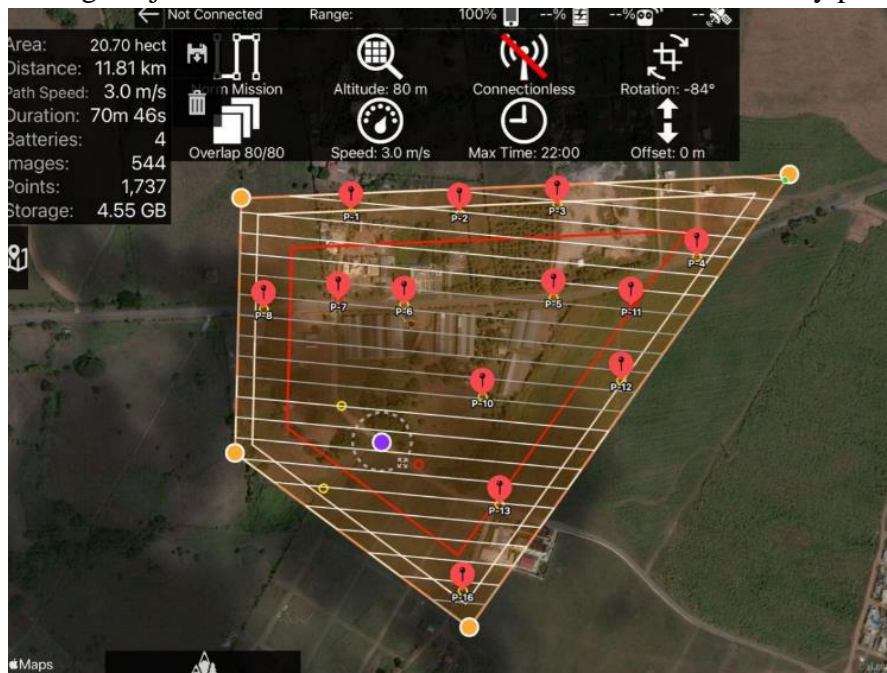
Figura 5: Ruta de vuelo en el programa Map Pilot (Fuente: De nuestra autoría)
