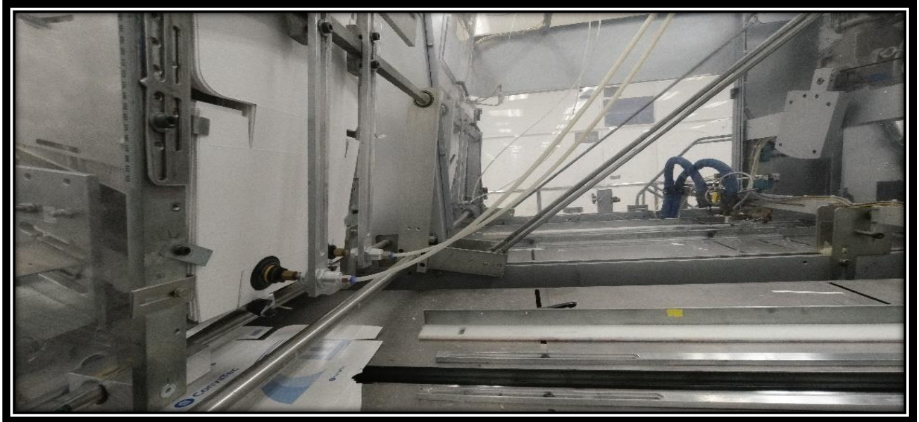
Figura 14: Sistema de succión al vacío para colocación de cartones en guía deslizante
