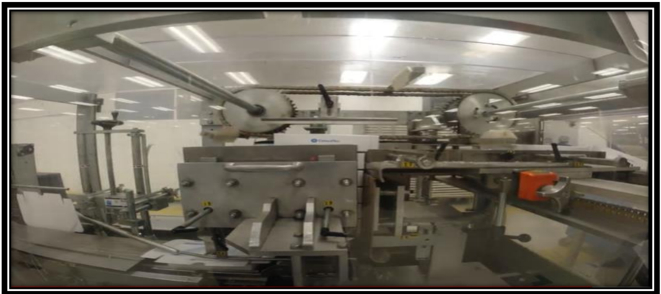
Figura 19: La base elevadora empuja el cartón hacia arriba cerrando las solapas y adheriendo el pegamento en los bordes de la tapa superior
