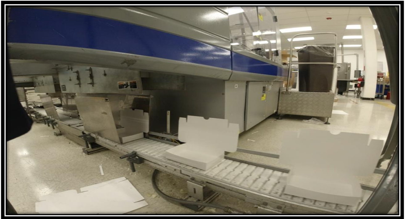
Figura 17: Descarga de Cartones en el Conveyor para dirigirse a la estación de cerrado del cartón
