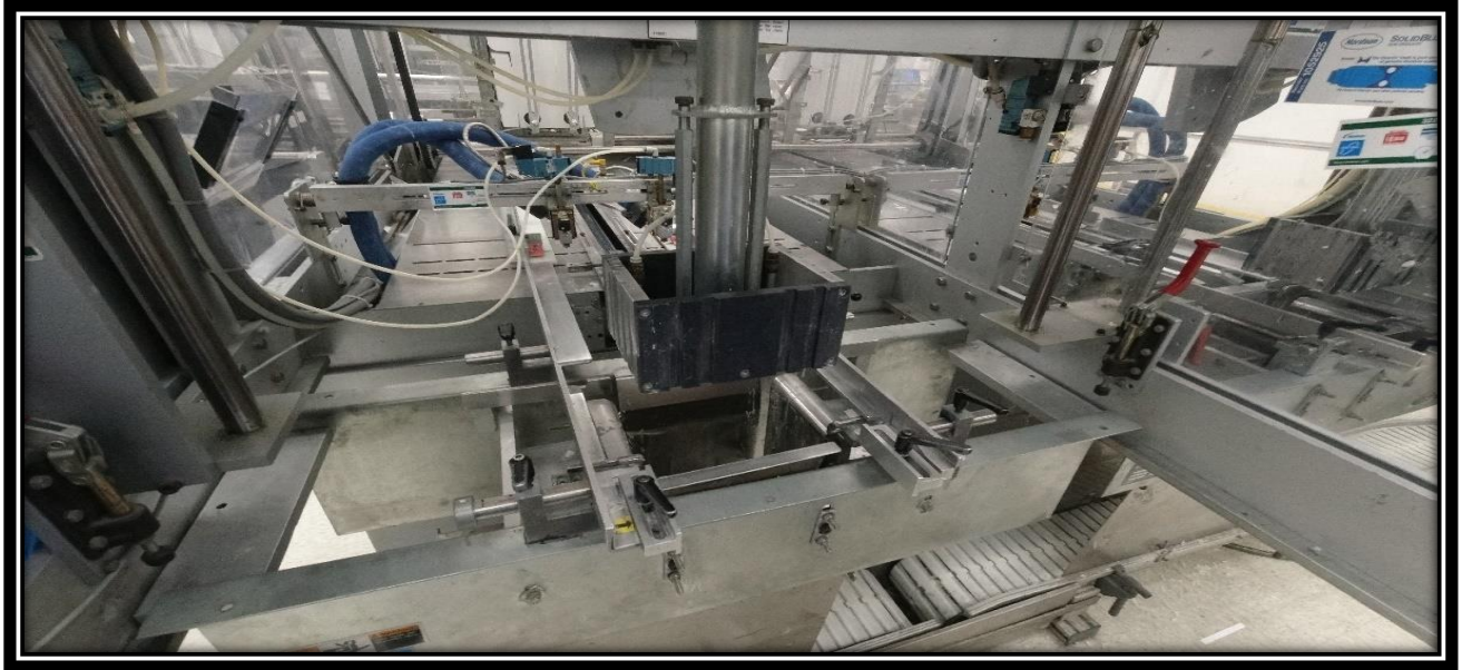
Figura 16: Estación de formado del cartón
