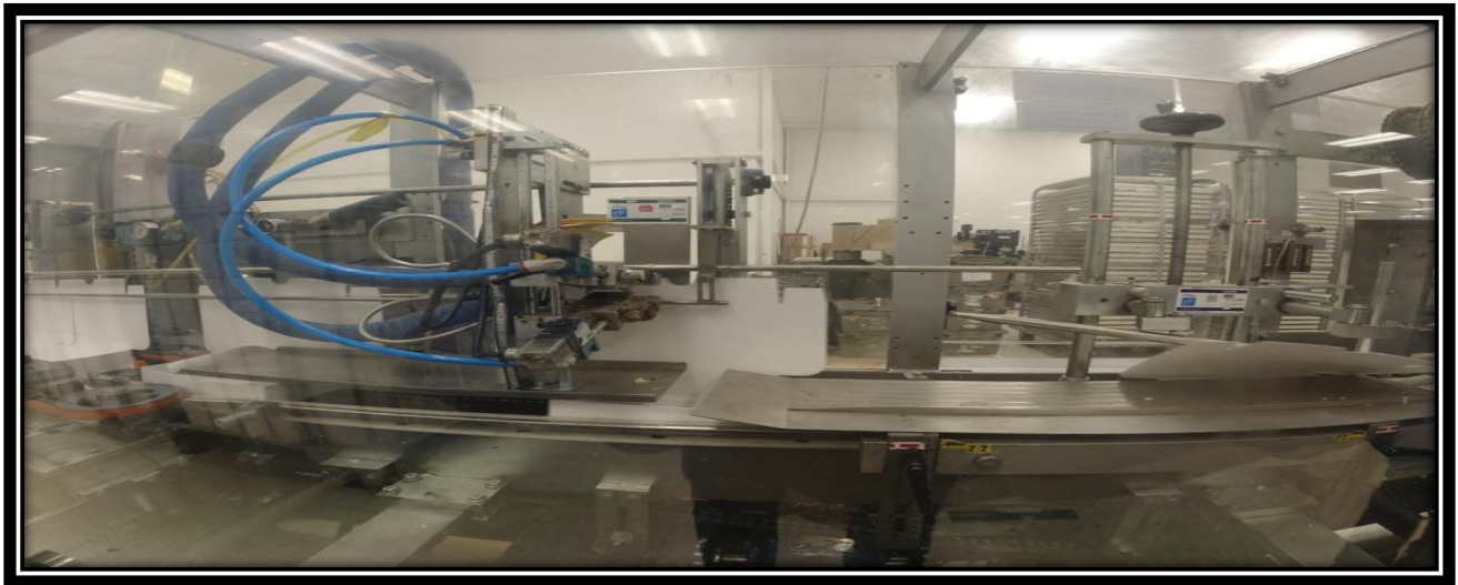
Figura 18: El cartón se mueve a la estación de encolado en donde se le aplica el pegamento, y se le dobla la tapa mediante una guía inclinada
