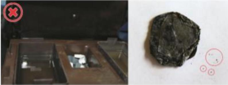
Figura 16. Partículas de laminas de plomo que se mojaron con los líquidos radiográficos.
