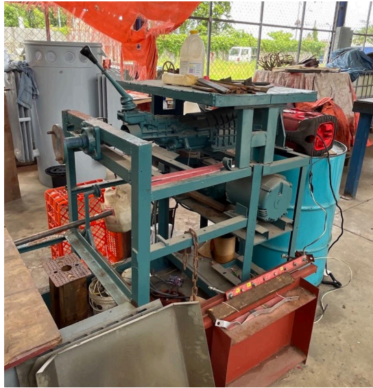
Ilustración 22. Máquina donde hacen las bobinas para los transformadores
