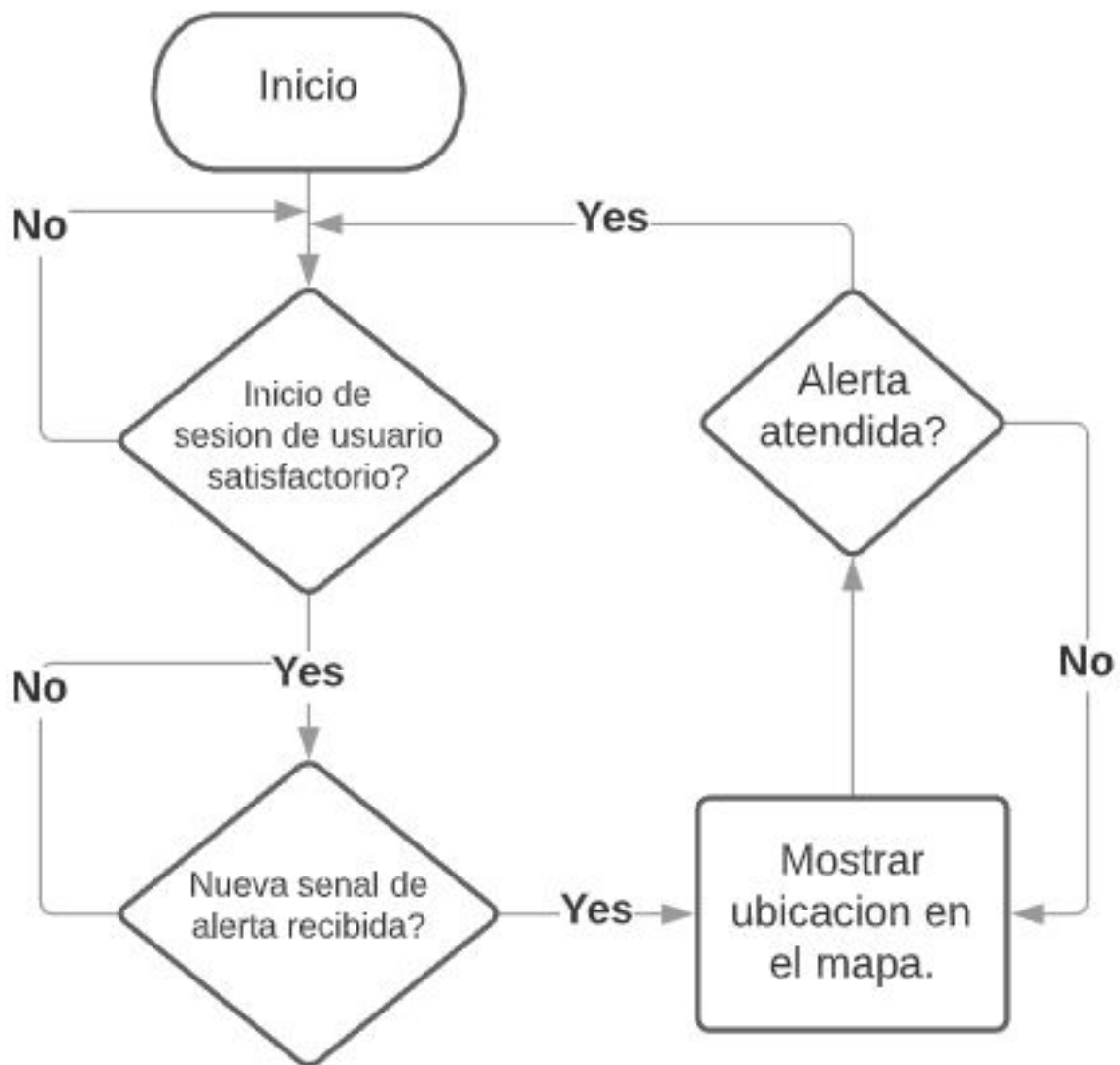
Figura 6.4.2. Diagrama de Procesos Dispositivo Electrónico - Sistema Portal Web. Elaboración propia, 2020.
