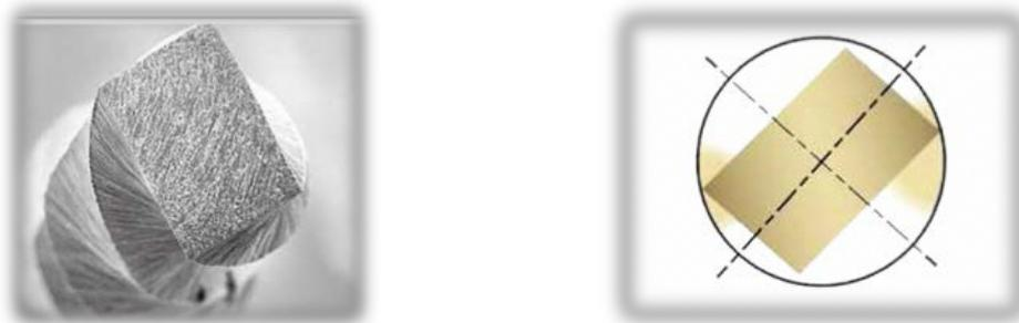
Figura 14: Sección transversal de una lima WaveOne Gold<sup>36</sup>
