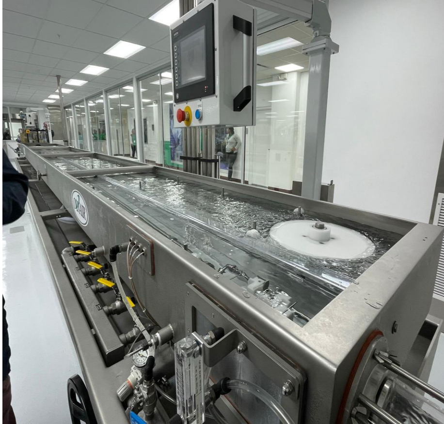
Anexo # 3 Fotografía de tanque de enfriamiento
