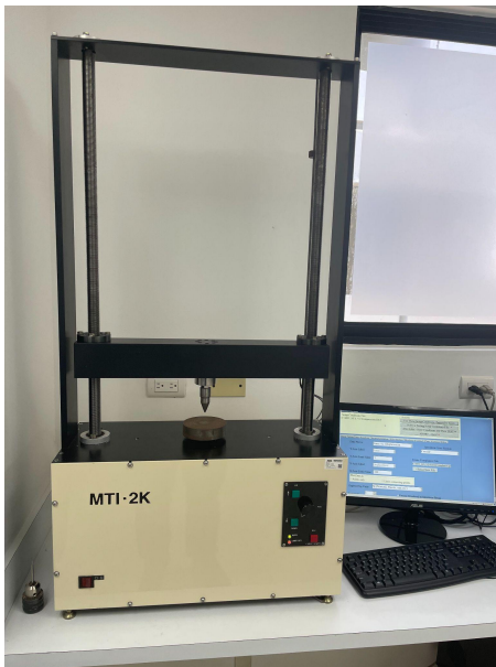
Figura 5. Equipo utilizado para medición de la muestra. A: MTI-2K. B: Punta cónica. C: fractura de la corona clínica del molar
