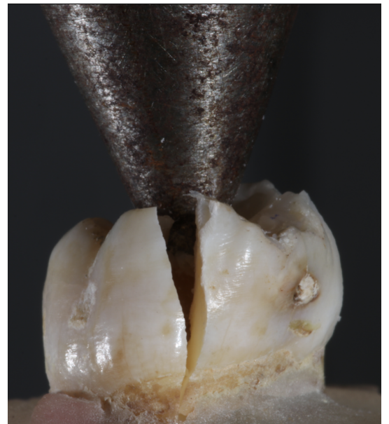
Figura 5. Equipo utilizado para medición de la muestra. A: MTI-2K. B: Punta cónica. C: fractura de la corona clínica del molar
