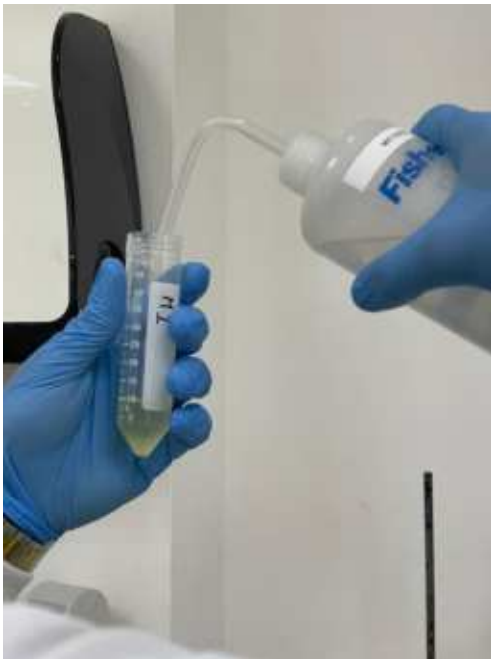
Imagen 12. Aquí se evidencia como 10 mL del aceite de una de las muestras de atún es mezclado con 25 mL de metanol.
