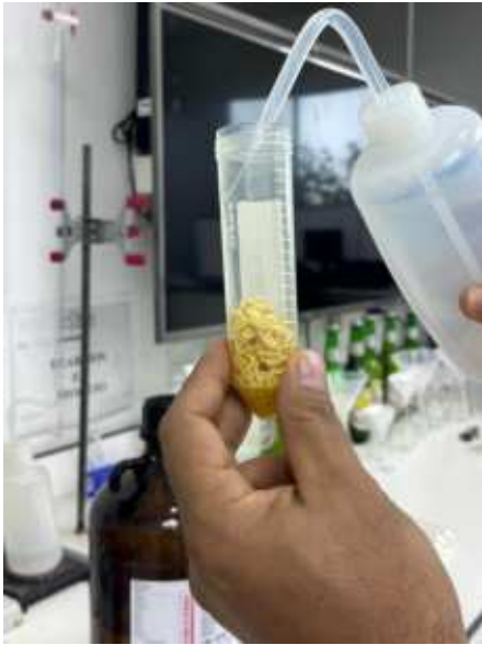
Imagen 5. Muestra de sopa triturada siendo mezclada con metanol.
