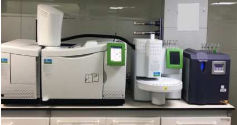
Imagen 1. Equipo utilizado GC/MS Clarus SQ 8, junto al TurboMatrix HeadSpace 40, ambos de la marca Perkin Elmer y unido a generador de hidrógeno de la marca Parker domnick hunter.
