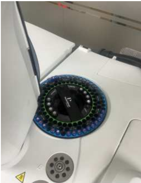
Imagen 10. Finalmente, aquí se pueden observar las diferentes muestras de las sopas instantáneas en el equipo utilizado GC/MS Clarus SQ 8.
