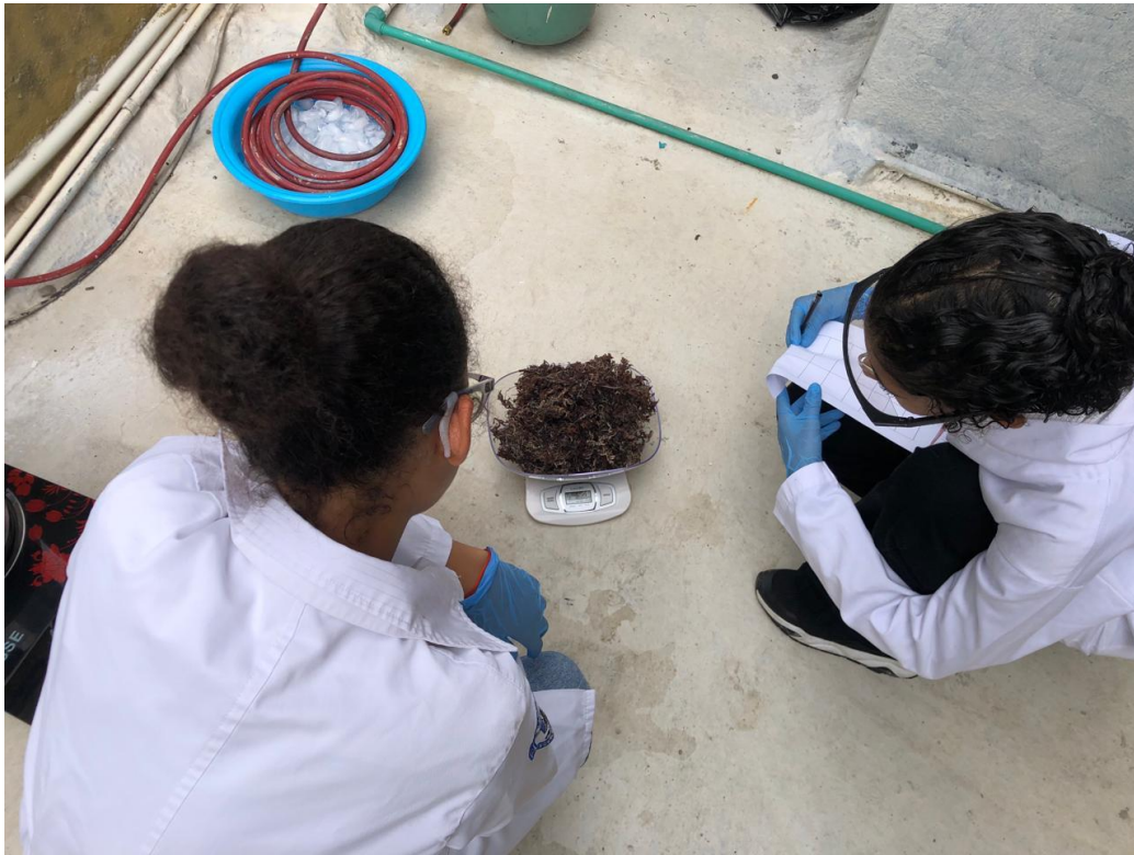
Anexo 22: Balanza digital con el peso de sargazo que se utilizaría para la prueba #2 (280 gramos)
