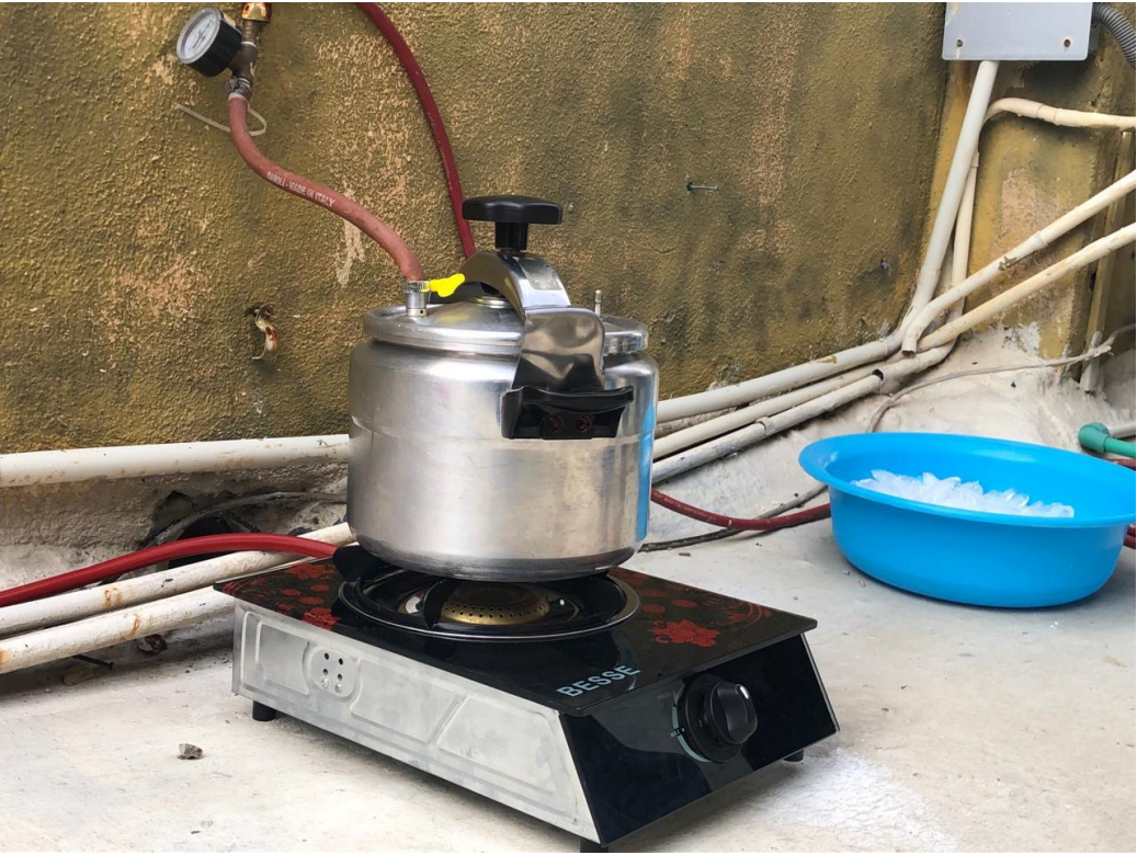
Anexo 13: Adaptación de la olla de presión y válvula reguladora
