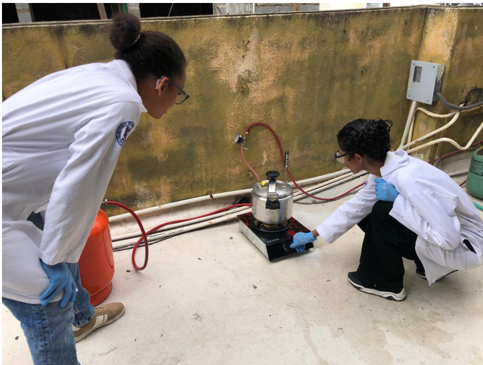
Anexo 35: Proceso para colocar el manómetro en la olla de presión
