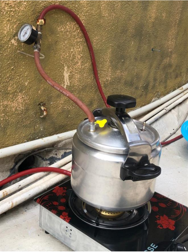
Anexo 13: Adaptación de la olla de presión y válvula reguladora
