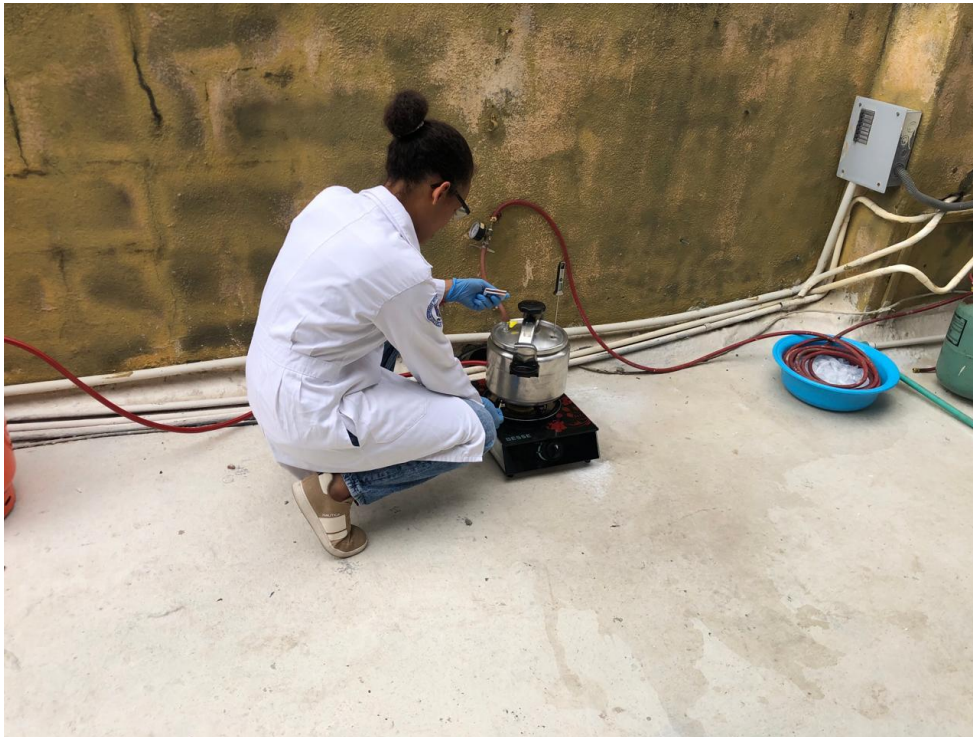
Anexo 35: Proceso para colocar el manómetro en la olla de presión
