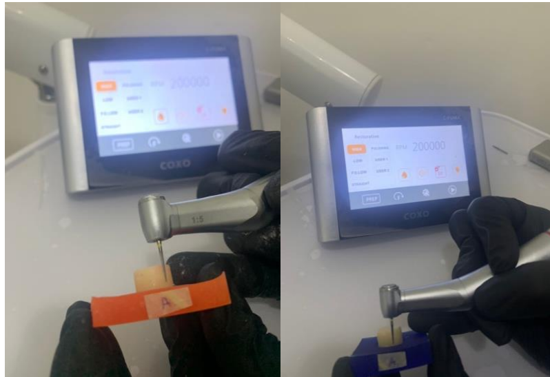
Figura 9: Eliminación de resina remanente a 20,000 rpm según las indicaciones del fabricante con fresa multilaminada Jota
