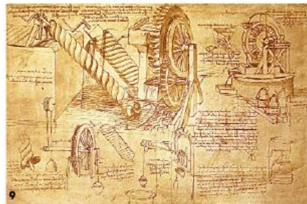
(9) "Tornillo de Arquímedes", un mecanismo por el cual se podía movilizar el agua en contra de la fuerza de gravedad dio origen al doble casco de las embarcaciones, el puente giratorio o múltiples aparatos.
