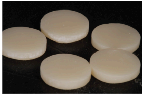
Imagen 8.A (Discos de resina VarseoSmile Crown Plus , Bego ™ a los 7 días en agua destilada).
