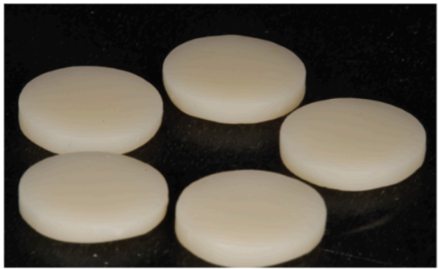
Imagen 4.A (Discos de resina Saremco Print Crowntec ™ a los 7 días en agua destilada).
