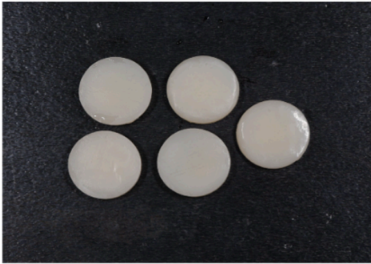
Imagen 4.A (Discos de resina Saremco Print Crowntec ™ a los 7 días en agua destilada).
