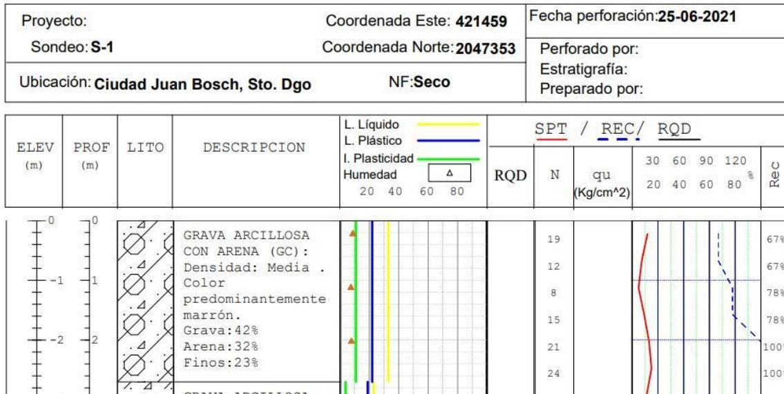
Fig. 8.1. Sondeo 1 de Informe geotécnico para la construcción de planta de aguas residuales en fase II Ciudad Juan Bosch, Santo Domingo Este.
