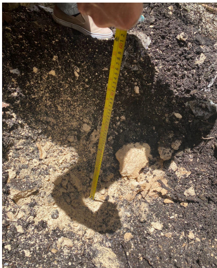
Figuras 7,8. Nota: Piedra caliza localizada a 30cm de profundidad, despues de la capa vegetal (Elaboración propia)
