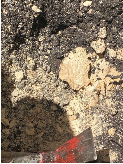
Figura 9. Nota: Roca caliza a 30 cm de profundidad (Elaboración propia)
