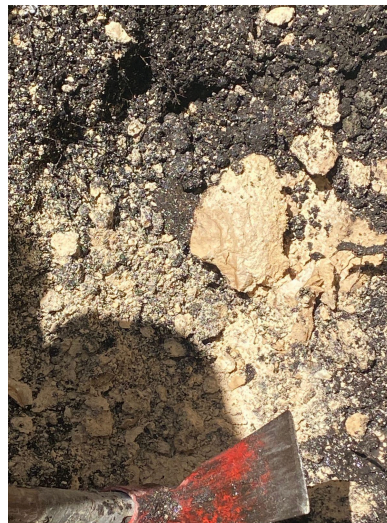
Figuras 7,8. Nota: Piedra caliza localizada a 30cm de profundidad, despues de la capa vegetal (Elaboración propia)
