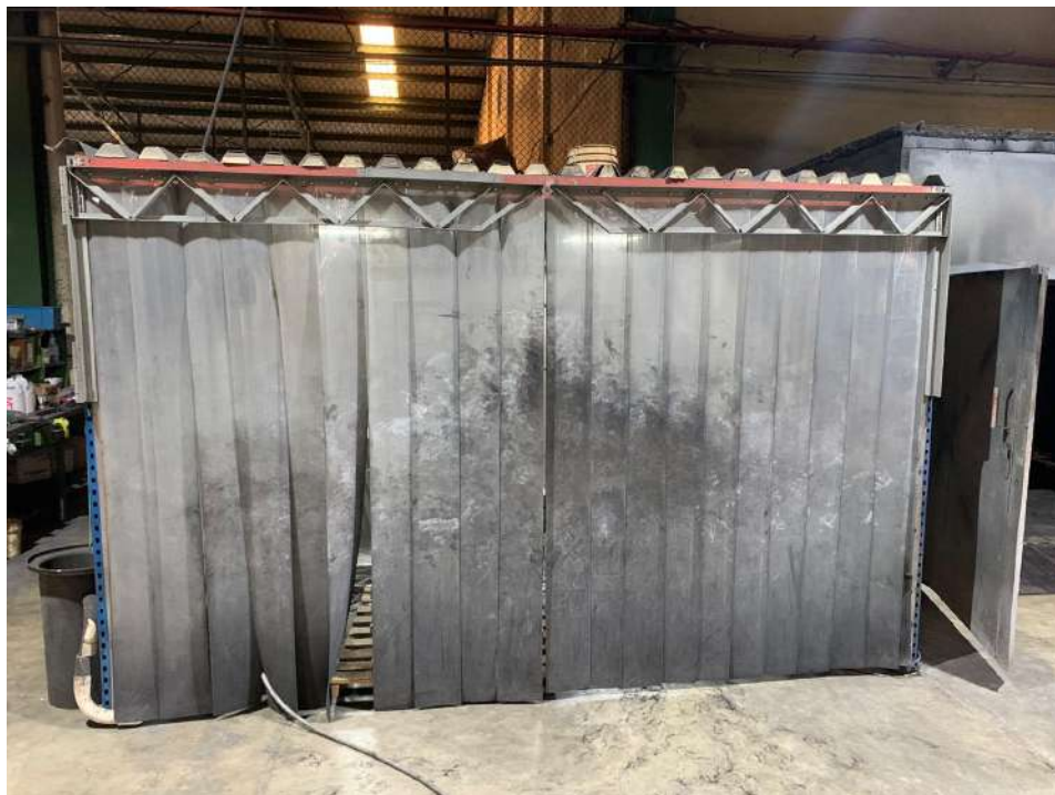
Anexo 15. Cabina de Pintura
