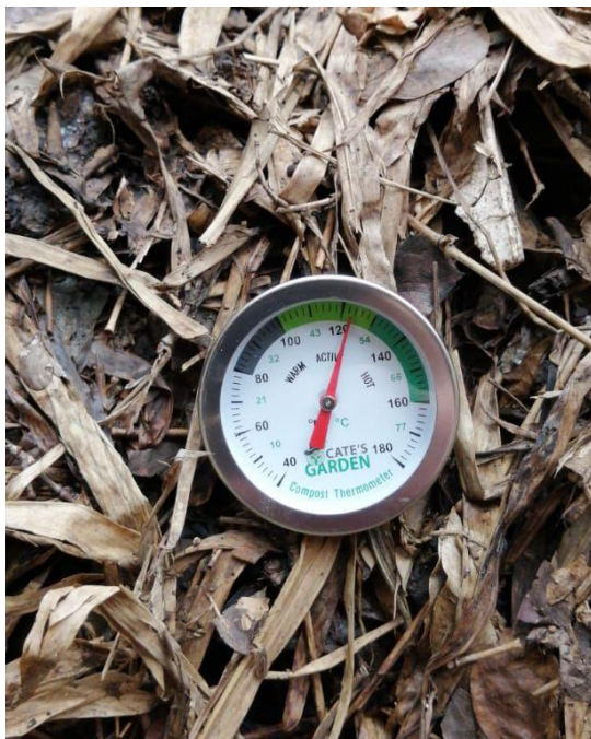
Ilustración No. 10 Inspección de Temperatura de la Pila de Compost.
