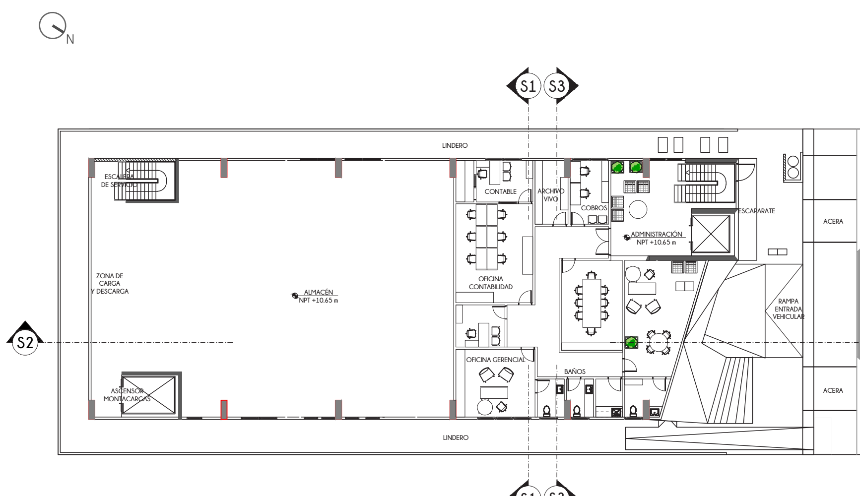
PLANTA ARQUITECTÓNICA EXISTENTE NIVEL 3 ESC. 1:250
