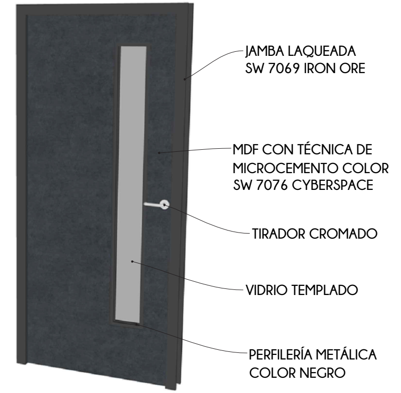
DETALLE PUERTA DE SERVICIO NIVEL 3 ESC. 1:30
