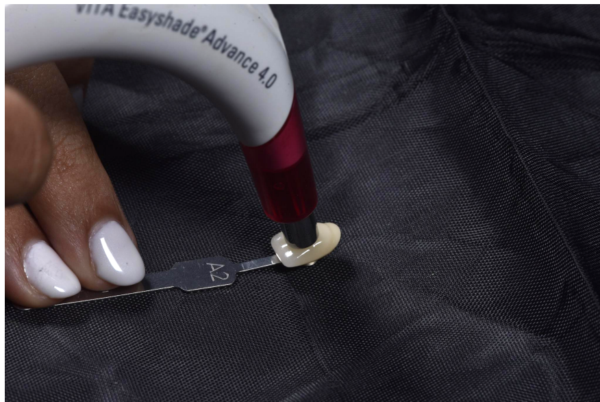
Figura 13: Se configuró el espectrofotómetro en medición única de color
